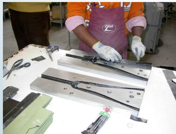
Sistemazione delle pelli e dei sacchetti interni di contenimento
