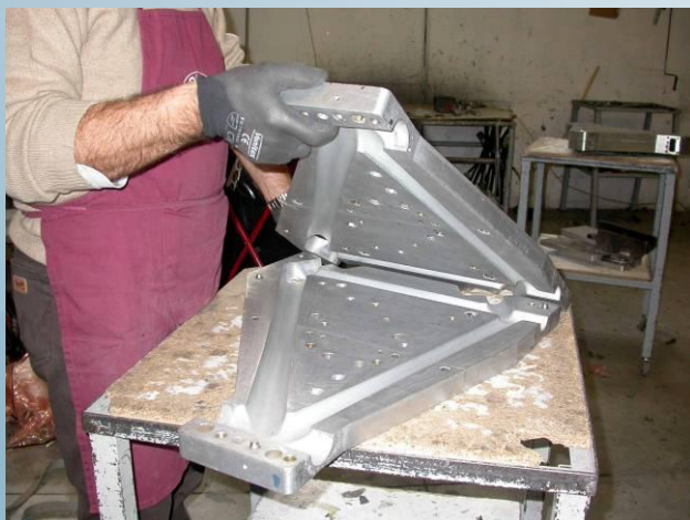
Stampo per monoscocca comprende il triangolo anteriore
