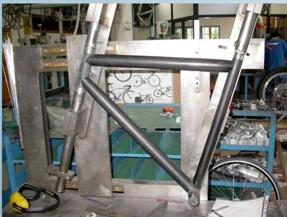
1 Taglio dei tubi, sgolatura e sistemazione in maschera
