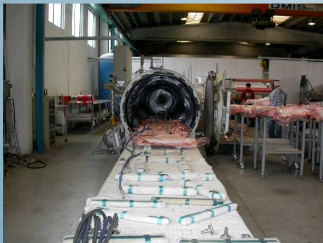
Stampi nei sacchi a vuoto sistemati in autoclave e finitura delle resine
