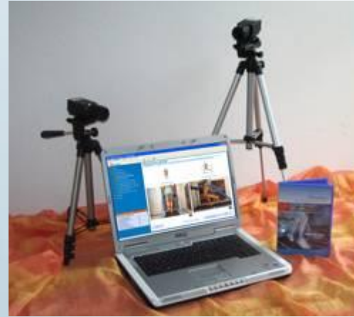
Fotocamere ad alta velocità 60 f/s
